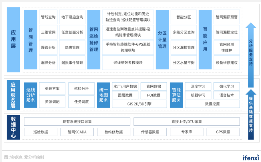
图 26：泉州水务智能管网智能监控
