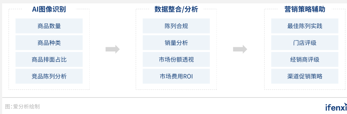
图 12： AIoT 陈列洞察冷柜的运行机制
